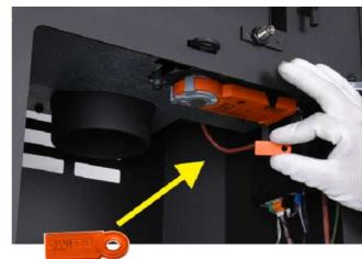
**! Im Falle eines Stromausfalls kann die Verbrennung auch manuell mit dem Luftreglerhebel gesteuert werden. Hierzu muss zur Deaktivierung der automatischen Steuerung der Magnetschlüssel am Servomotor angebracht werden. Außerhalb der Heizperiode empfehlen wir, die Steuerung von der Netzspannung zu trennen.**
